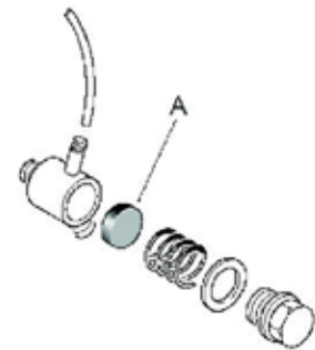
Afb. 9 Afdichtingselement in het terugslagventiel
