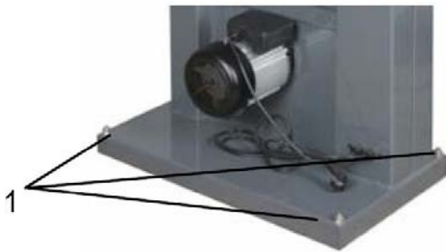
Fig. 4: Montage op de ondergrond
