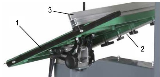
Fig. 6: De schulpgeleider monteren
