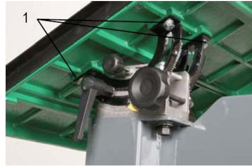
Fig. 5: Montage van de zaagtafel
