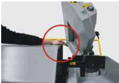
Afb. 25 Gevaarlijke plaats zaagarm
