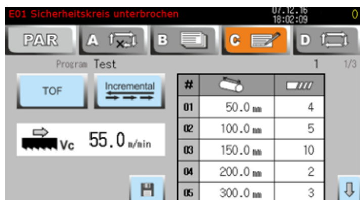
Afb. 41 Parameters van het snijprogramma
