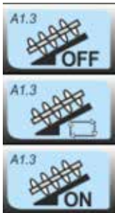
Afb. 24 AAN/UIT schakelaar voor de spanentransporteur
