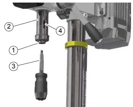
Figuur 4-3: Het gereedschap/de boorhouder uitbouwen
