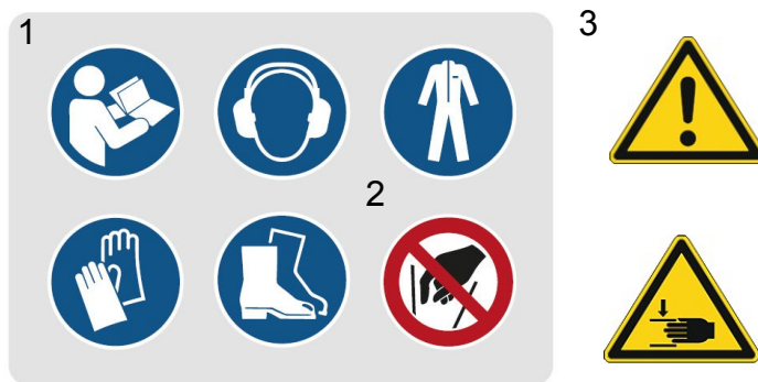
Fig.1-1: Veiligheidsmarkeringen - 1 Verplicht teken: Gebruiksaanwijzing in acht nemen, gehoorbescherming gebruiken, beschermende kleding gebruiken, handbescherming gebruiken, voetbescherming gebruiken, | 2 Verbodstekens: Waarschuwbord: algemeen waarschuwbord, waarschuwing voor verwondingen aan de handen.
