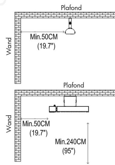
De radiator moet ten minste 1,8 meter boven de vloer worden geïnstalleerd.
