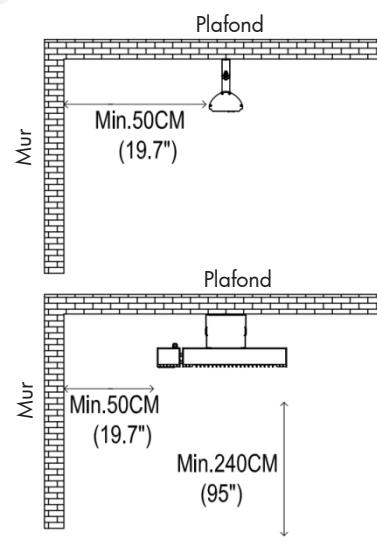
Le radiateur doit être installé à au moins 1,8 mètre au-dessus du sol.
