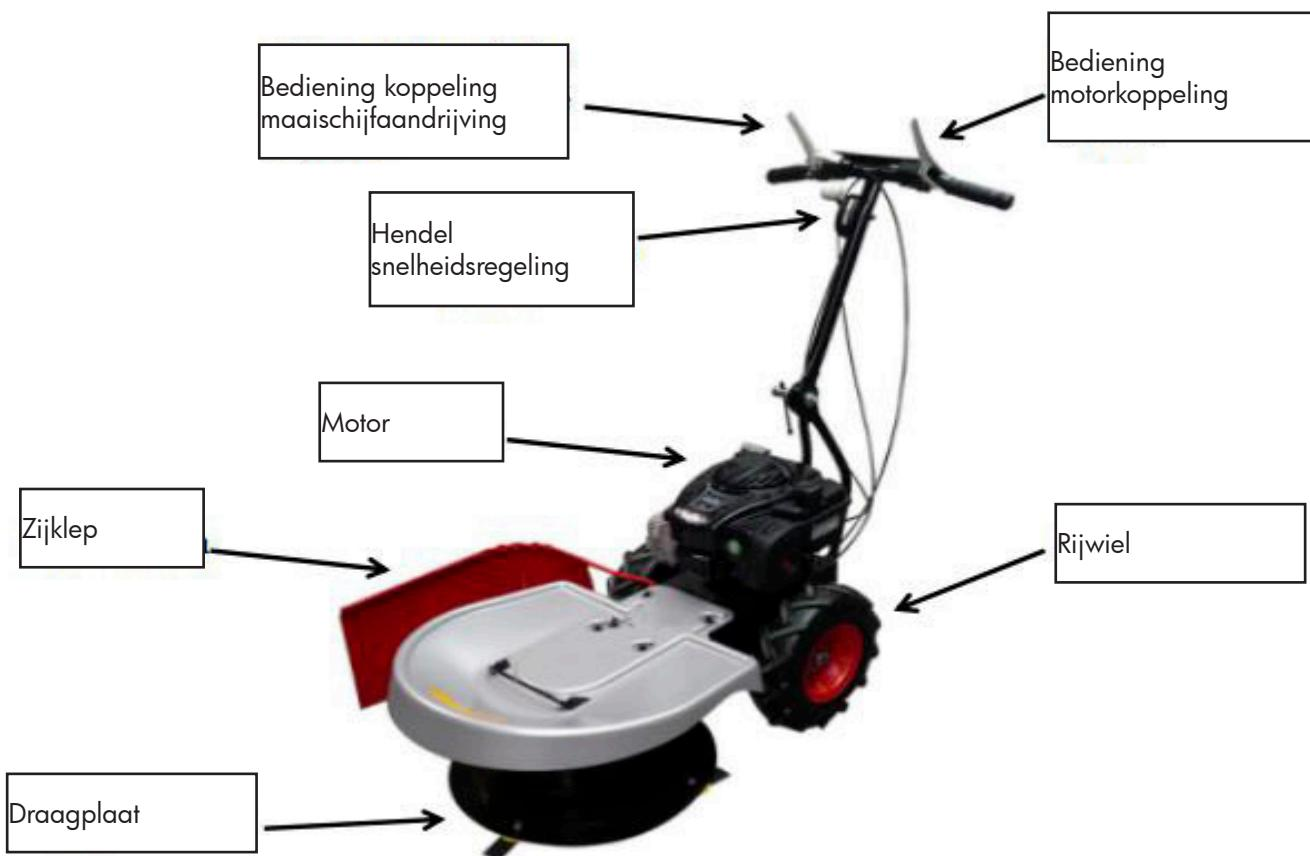
De basis van de machine is een stevig frame. Op het bovenste deel van het frame bevindt zich een 4-takt verbrandingsmotor, die de maaischijf aandrijft via de V-riem. De aandrijving van de maaischijf wordt ingeschakeld door een spanrol die wordt bediend met een hendel op het stuur.
