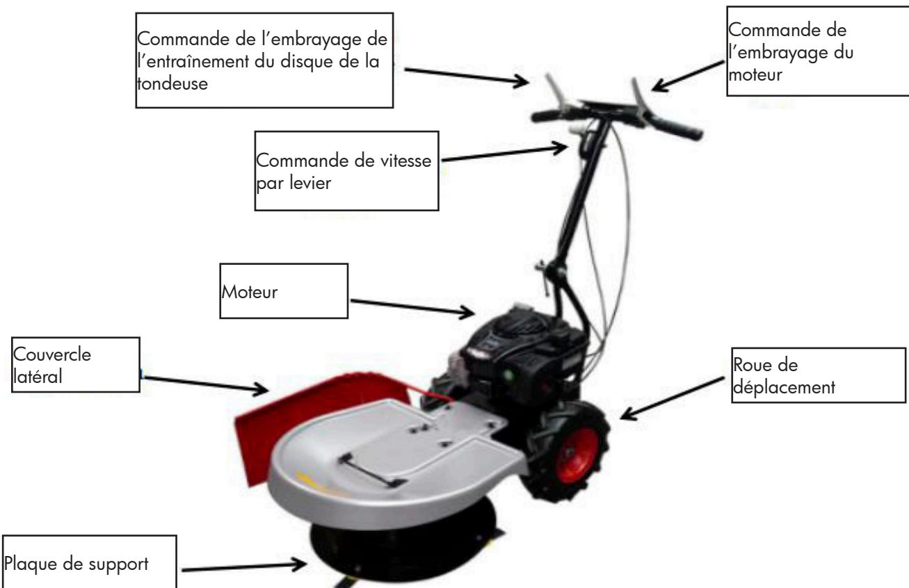
La base de la machine est un cadre rigide. Sur la partie supérieure du châssis se trouve un moteur à combustion à 4 temps, qui entraîne le disque de coupe par l'intermédiaire d'une courroie trapézoïdale. L'entraînement du disque de coupe est activé par une poulie de tension commandée par un levier situé sur le guidon.
