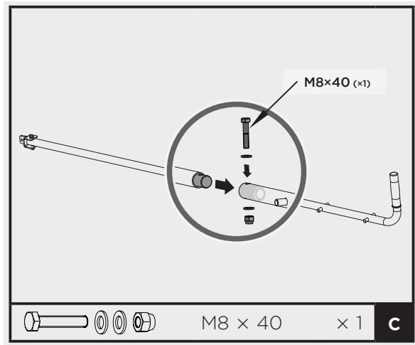
4. Bevestig de bedieningshendel aan de geleidebus. Lijn de gaten uit en bevestig ze met M8x35 bout, sluitringen en moer.
