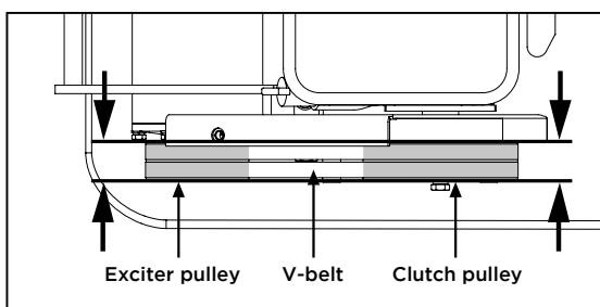
3. Faites glisser le moteur vers l'avant de la plaque, glissez la courroie usagée en bas de la poulie et installez la nouvelle courroie en place.
