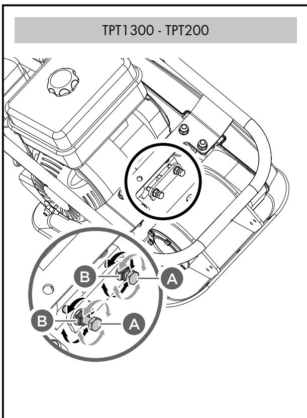
3. Desserrez les écrous B en laissant suffisamment d'espace entre les écrous et le support.
