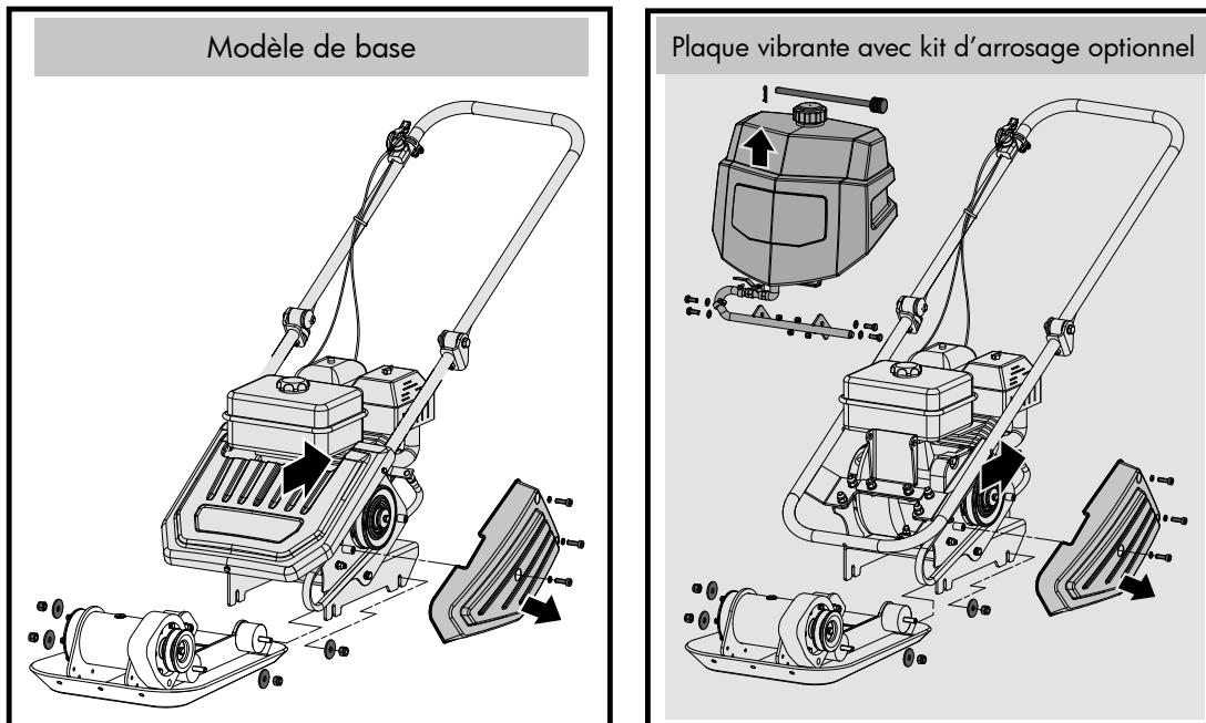
2. Enlevez le garde-courroie et la courroie en V.
