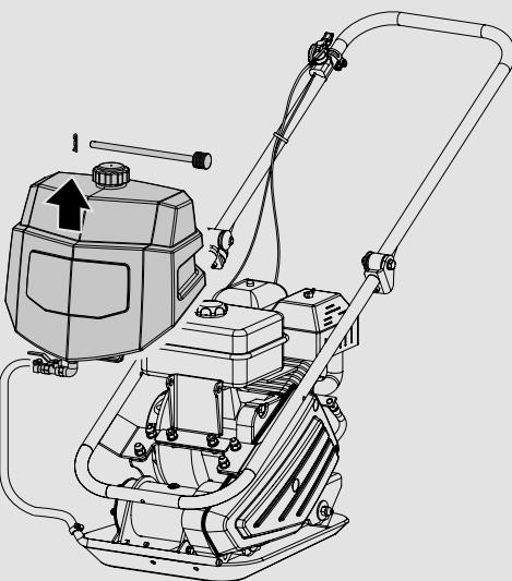
1. Verwijder de motorkap of het waterreservoir.
