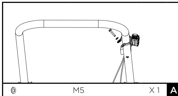
Dévissez le boulon 5x35 de la commande des gaz. Fixez la commande des gaz sur la poignée supérieure avec une rondelle 5 et le boulon 5x35 que vous venez de dévisser.
