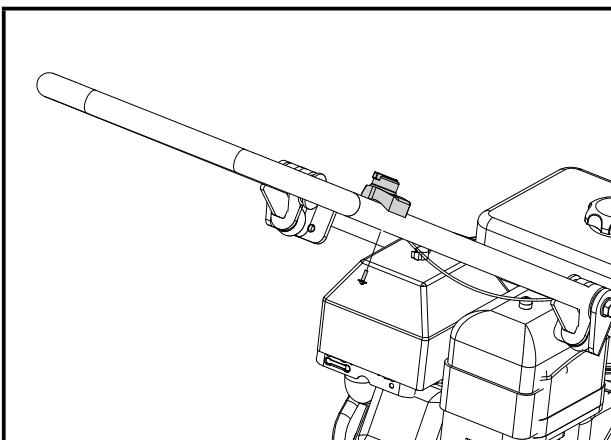
Verwijder de schroef van de schakelaar, lijn het gat in de handgreep uit met het gat in de schakelaar. Steek de schroef in het gat en draai deze aan.
