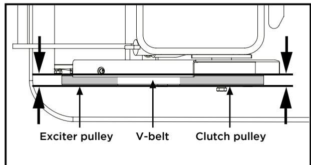
4. Poussez le moteur vers l'arrière de la plaque en tournant les boulons de réglage A pour éliminer le jeu de la courroie.
