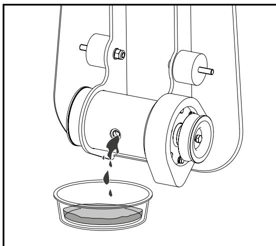
5. Verwijder de afvoerdop van de excitator frame. Til het frame en kantel dit, om de olie af te tappen. Controleer of de olie metalen deeltjes bevat.
