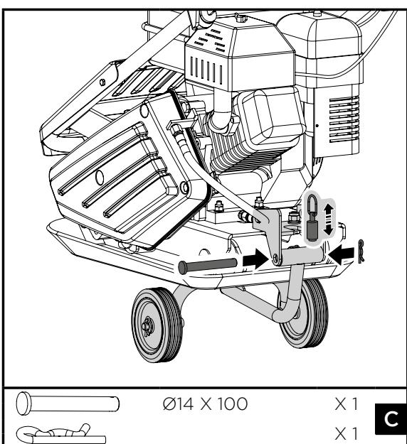
2. Trek de veerbout en omhoog en plaats de bovenste buis van de wielenstein in de montagebeugel. Lijn beide uiteinden van de buis uit met de gaten. Schuif de bout naar binnen en bevestig met de clips.
