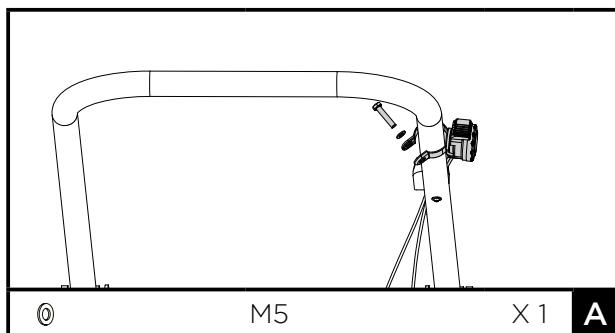
Draai de bout 5x35 van de gashendel los. Bevestig de gashendel op de bovenhandgreep met een sluitring 5 en de bout 5x35 die net losgedraaid werd.
