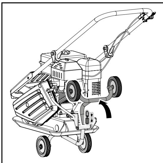
6. Tirez le boulon à ressort et repliez le support des roues.
