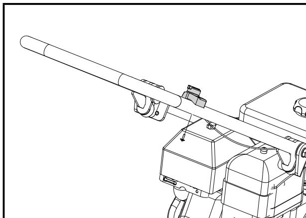
Enlevez la vis de l'interrupteur, alignez le trou dans la poignée avec le trou dans l'interrupteur. Insérez la vis dans le trou et serrez-la.
