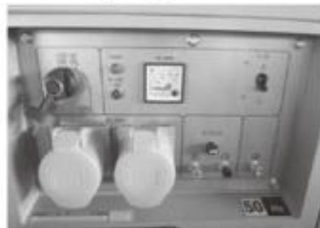
Avant de faire démarrer le générateur, vérifiez que l'interrupteur est en position OFF. Faire démarrer le générateur avec l'interrupteur sur ON est très dangereux. Le générateur doit être mis à la terre, pour éviter les chocs électriques.
