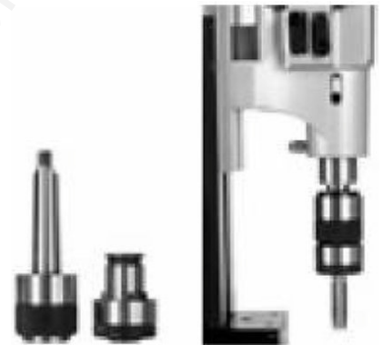
Afb. 21: Uitbouw voor draadsnijden
