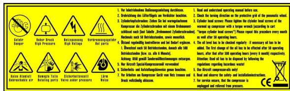
Fig. 1 : Veiligheidsmarkeringen op de compressor
