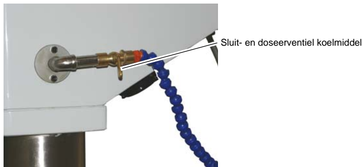
Abb.4-13: Sluit- en doseerventiel koelmiddel
