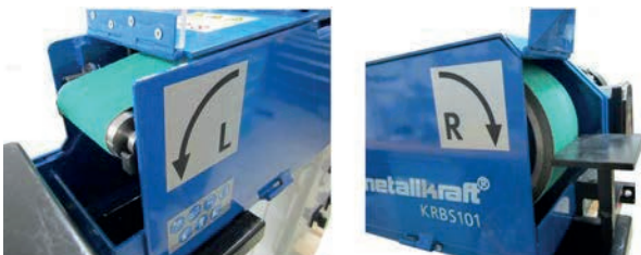
Afb. 18: Draairichtingen L en R van de slijpband
