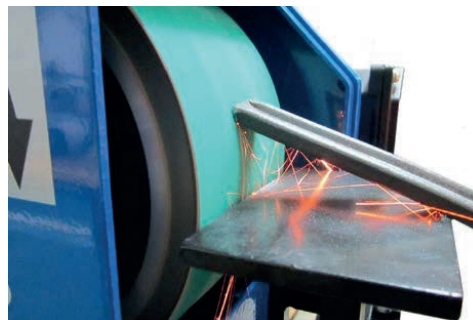
Afb. 21: De vonken worden naar beneden gericht als de draairichting correct is
