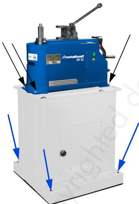
Fig. 14: Verankering van de buigmachine
