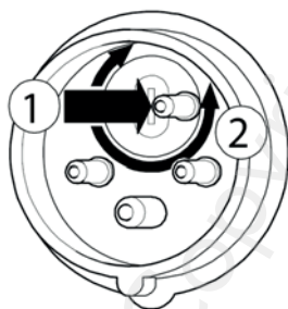
Afb. 9: De draairichting van de motor wijzigen
