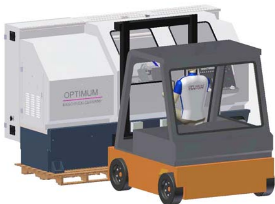
Afb. 3-1 Transport met een vorkheftruck
