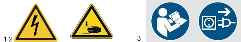
Fig. 1: Veiligheidsmarkeringen - 1 Waarschuwing voor gevaarlijke elektrische spanning 2 Gevaar voor beknelling van bovenste ledematen 3 Verplicht teken
