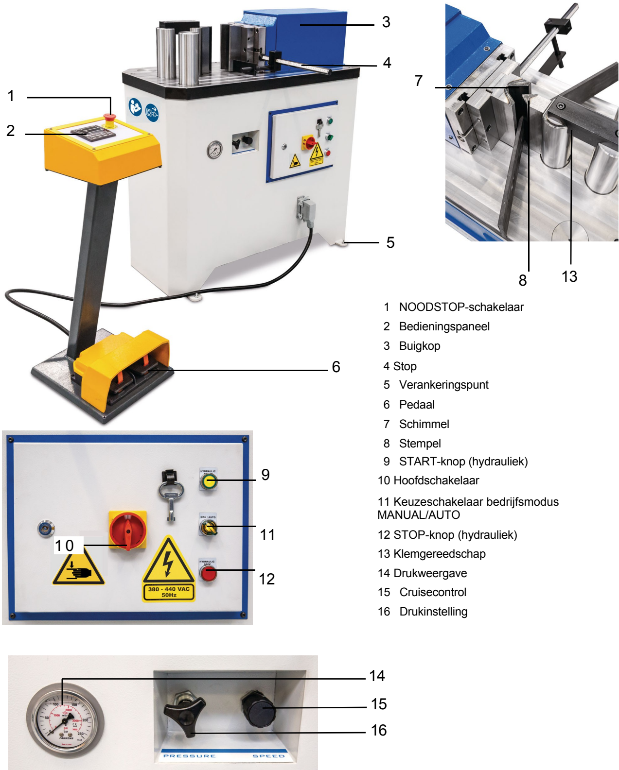
Fig. 5: Aanzicht van de buigpers HBP-serie | Versie 1.08 | NL
